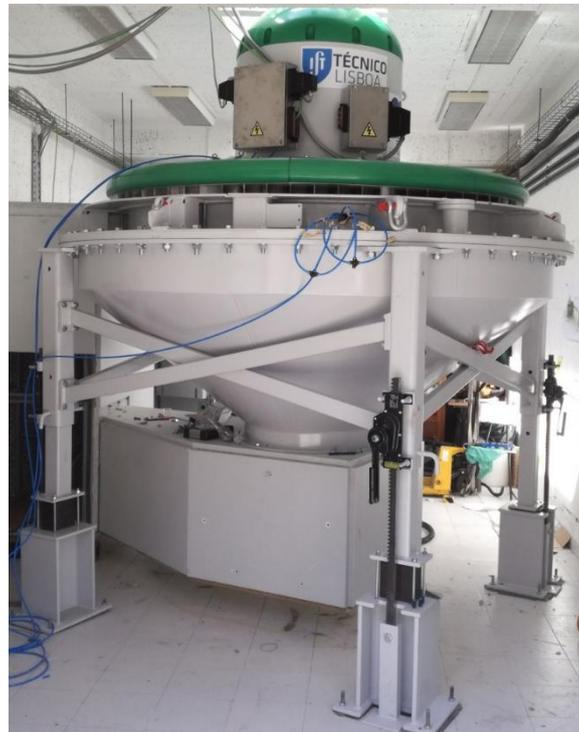
**FIGURE 21: OPERA BIRADIAL TURBINE BEING TESTED AT IST.**
