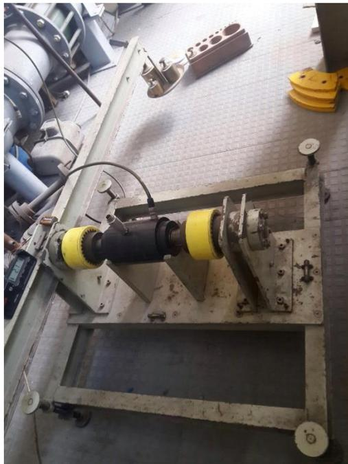
**FIGURE 9: TORQUE-METER CALIBRATION SENSORS.**
